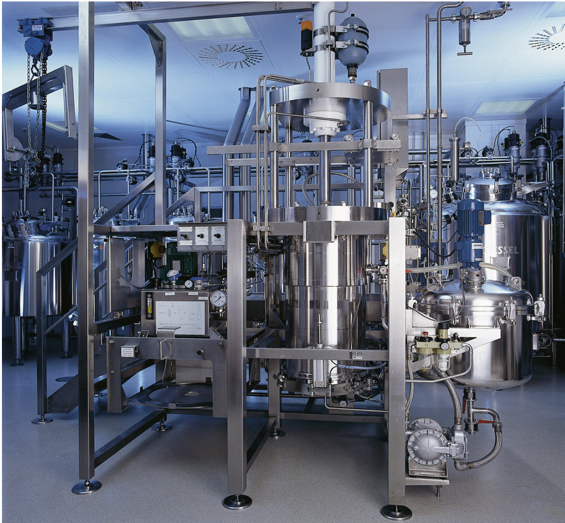
Anlage zur chromatographischen Aufreinigung
