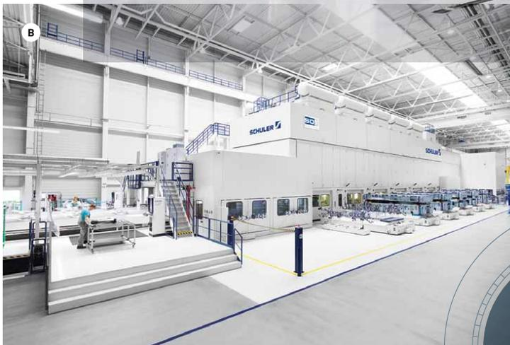
3 Minuten dauert ein vollautomatischer Werkzeug- und Toolingwechsel auf einer sechsstufigen Servopressenlinie.
