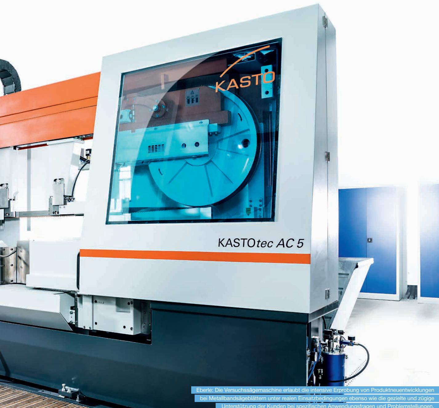
Eberle: Die Versuchssägemaschine erlaubt die intensive Erprobung von Produktneuentwicklungen bei Metallbandsägeblättern unter realen Einsatzbedingungen ebenso wie die gezielte und zügige Unterstützung der Kunden bei spezifischen Anwendungsfragen und Problemstellungen.
