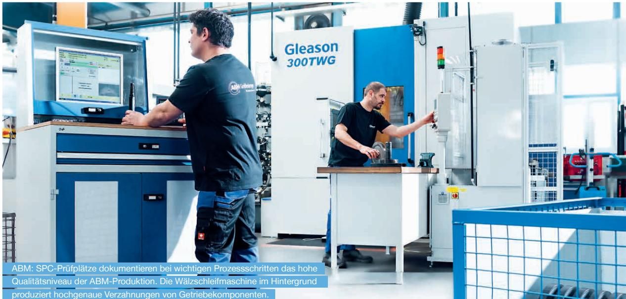
ABM: SPC-Prüfplätze dokumentieren bei wichtigen Prozessschritten das hohe Qualitätsniveau der ABM-Produktion. Die Wälzschleifmaschine im Hintergrund produziert hochgenaue Verzahnungen von Getriebekomponenten.
