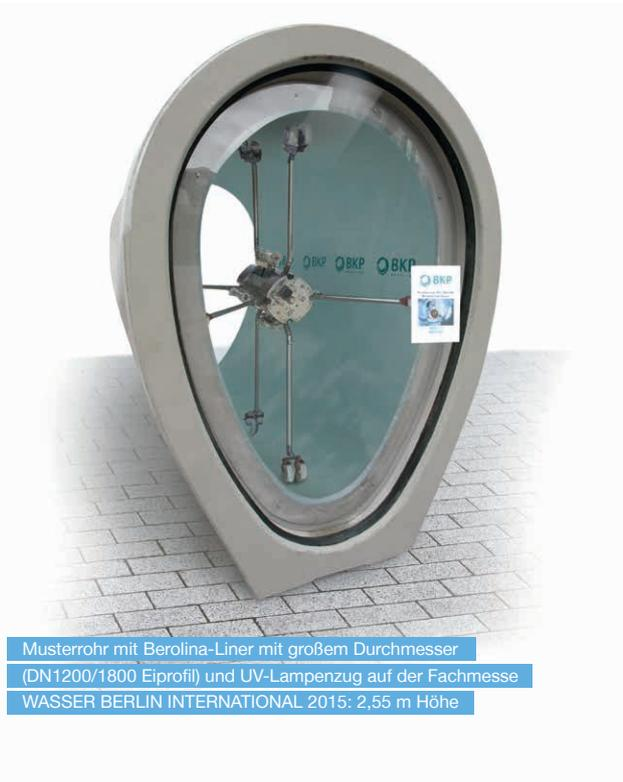
Musterrohr mit Berolina-Liner mit großem Durchmesser (DN1200/1800 Eiprofil) und UV-Lampenzug auf der Fachmesse WASSER BERLIN INTERNATIONAL 2015: 2,55 m Höhe
