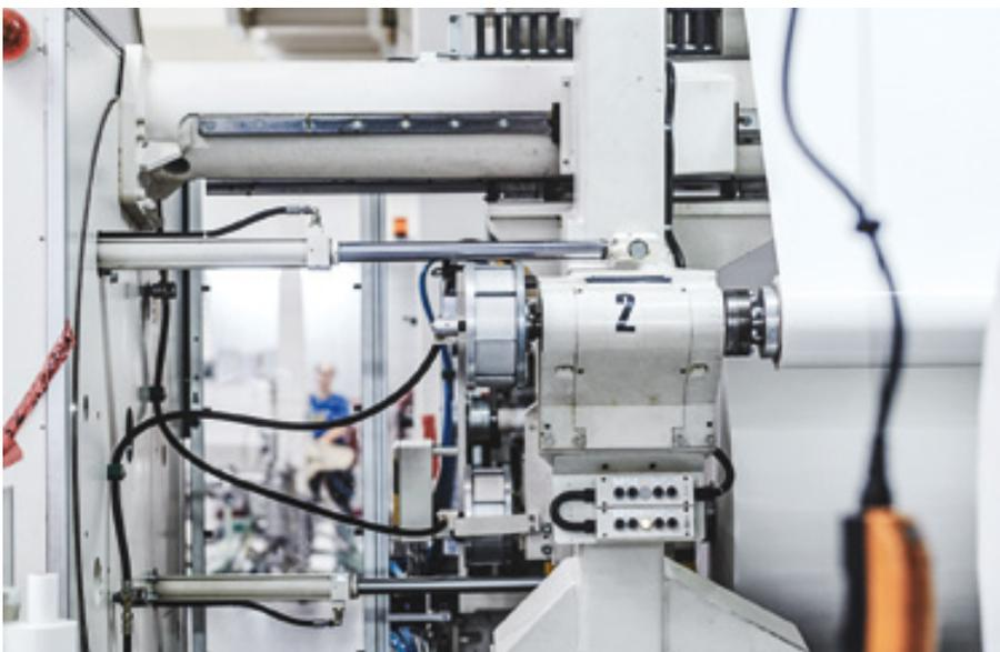
Von der Rollenabwicklung des Endloswickelsterns werden bei der Klebefolienherstellung die Rohmaterialien zugeführt.
