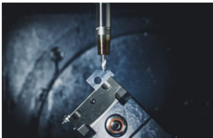
Fräszyklus bei der Herstellung eines Gelenkstücks durch präzise CNC 5 Achs-Bearbeitungszentren.
